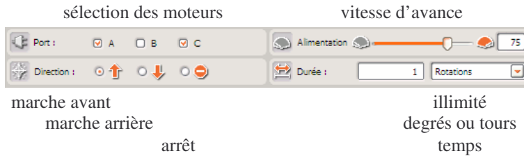
sens de rotation du moteur en marche avant
